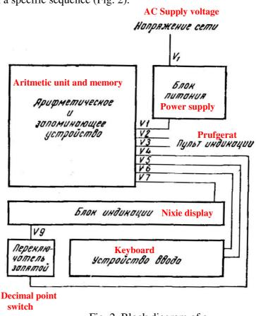
Fig. 2. Block diagram of a « Soemtron-220 » computer.
